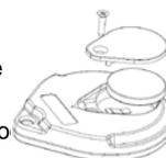
**Remarque :** le remplacement des piles des claviers et des télécommandes doit être réalisé en moins de 2 minutes pour éviter d'envoyer un signal antisabotage au poste de surveillance central.
